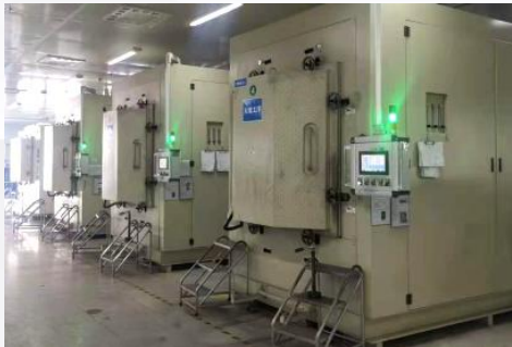
구리판 확산 용접
